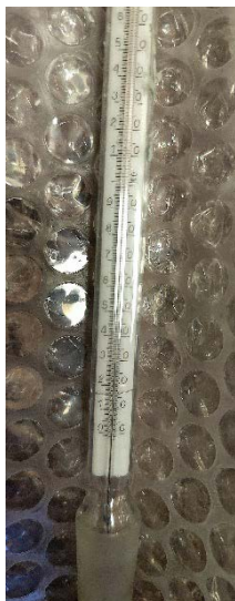
рис.4 Термометр, использующийся для температуры в контейнере.
