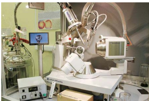
Рис.6 дифрактометр Xcalibur, общий вид
