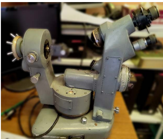
Рис.5. Двукружный отражательный гониометр ГД-1.
