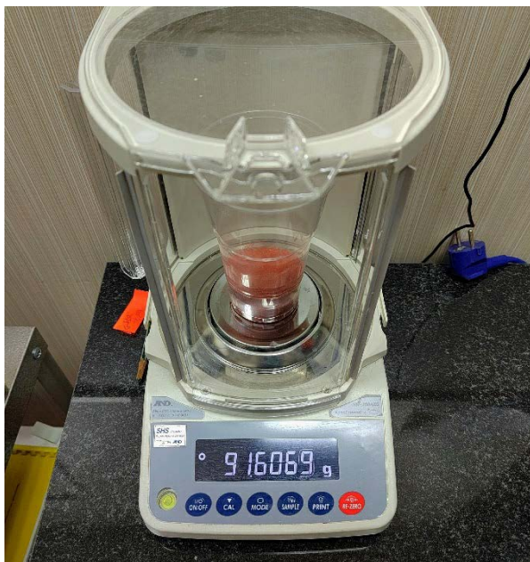
рис. 3. Аналитические весы AND HR – 250AZG
