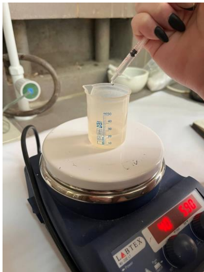
Рис.5. Подготовка шихты для синтеза 1 (а-перемешивание магнитной мешалкой, б – нагревание при 40°, в,г – прибавление по каплям 1 мл кремнезоля, д – полученный гель с рН=5,5
