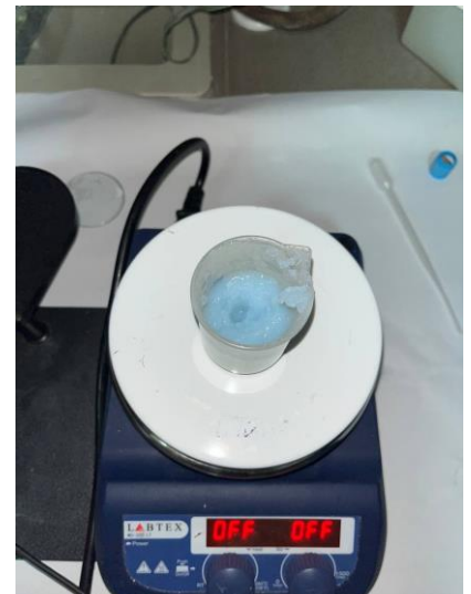
Рис.5. Подготовка шихты для синтеза 1 (а-перемешивание магнитной мешалкой, б – нагревание при 40°, в,г – прибавление по каплям 1 мл кремнезоля, д – полученный гель с рН=5,5
