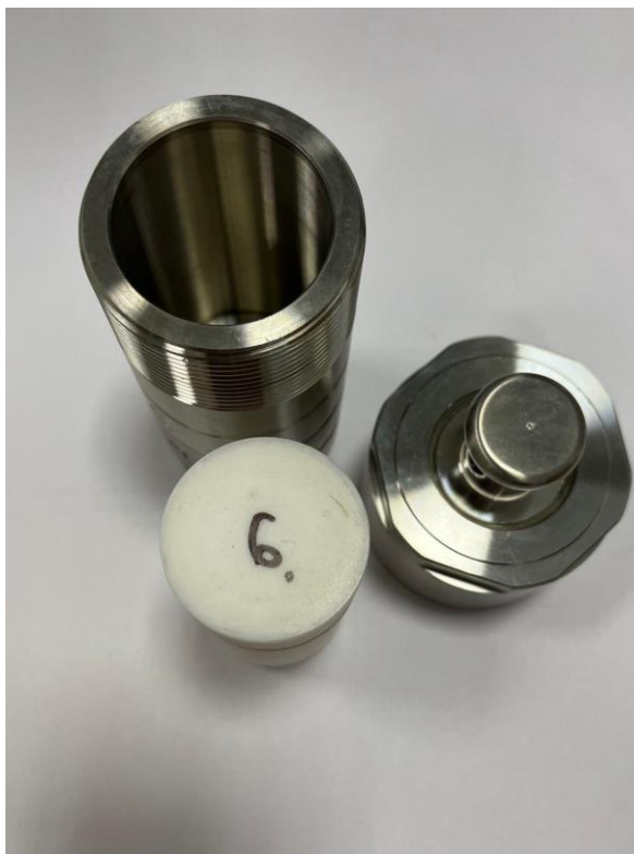
Рис. 6. Автоклав для гидротермального синтеза
