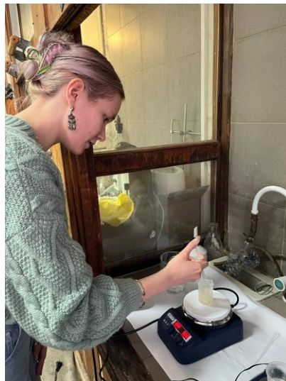
Рис.5. Подготовка шихты для синтеза 1 (а-перемешивание магнитной мешалкой, б – нагревание при 40°, в,г – прибавление по каплям 1 мл кремнезоля, д – полученный гель с рН=5,5
