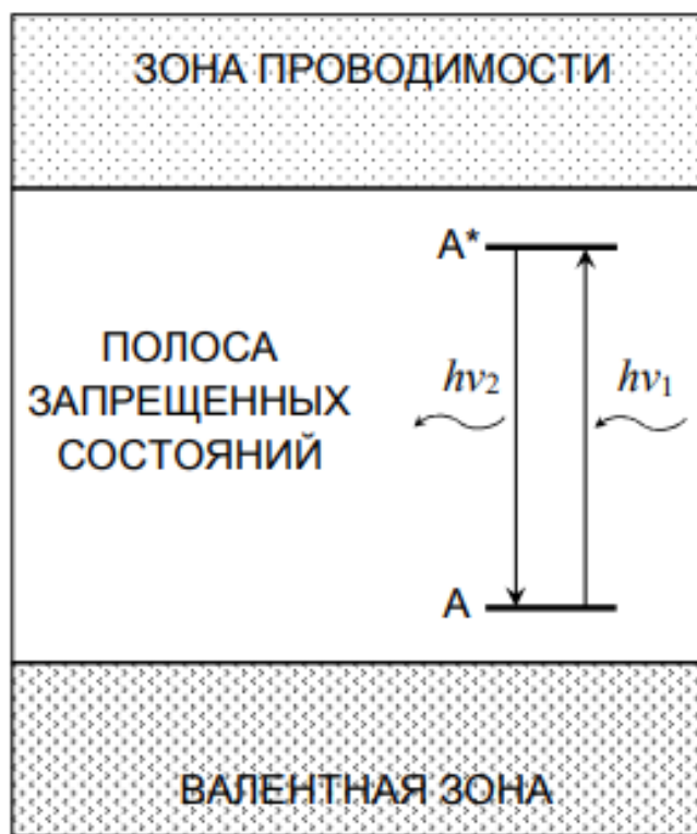
Рис. 4. Схема внутрицентровой люминесценции
