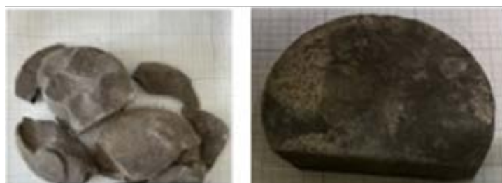
Определение водосодержания и минерализации пластовой воды по “сухому” (архивному) керну.
