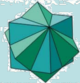
ДВОЙНИК ПРОРАСТАНИЯ ПО ШПИНЕЛЕВОМУ ЗАКОНУ ПО {111} характерен для шпинели, флюорита, допарита Операция двойникования - поворот на 180° вокруг [111] Точно также же для кубических кристаллов дают отражение в {111}, {211}, {121}, {112}, поворот на 60° вокруг [111], а также повороты на ~70,5° вокруг [110], [101] и [011]
