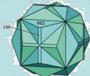
ДВОЙНИК ПРОРАСТАНИЯ ПО СПИРИТОВОМУ ЗАКОНУ - "ЖЕЛЕЗНЫЙ КРЕСТ" Операция двойникования - отражение в {110} Точно такой же результат дает поворот на 180° вокруг [110] и поворот на 90° вокруг [001]
