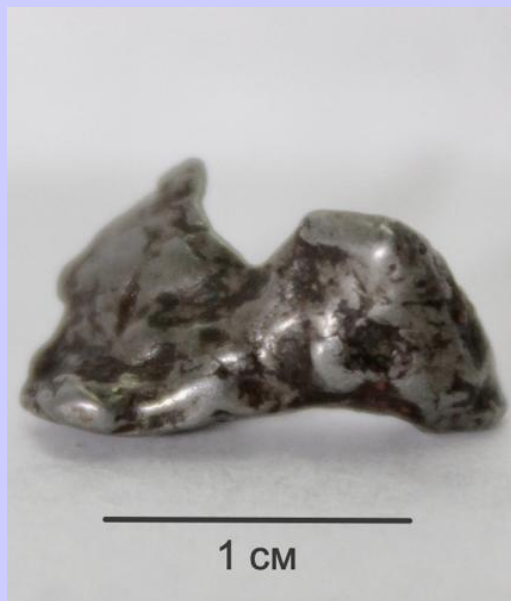
Метеорит - однородный Fe-Ni сплав – камасит
