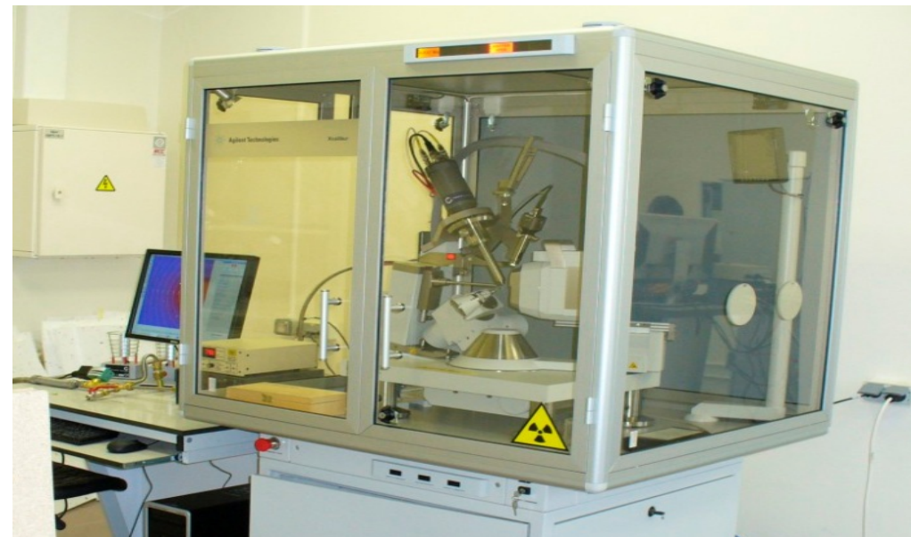
Гониометрический блок монокристалльного дифрактометра современного рентгеновского
