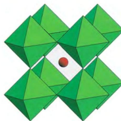
Рис. 2-2. Полиэдрическая модель неискаженной структуры перовскита.
