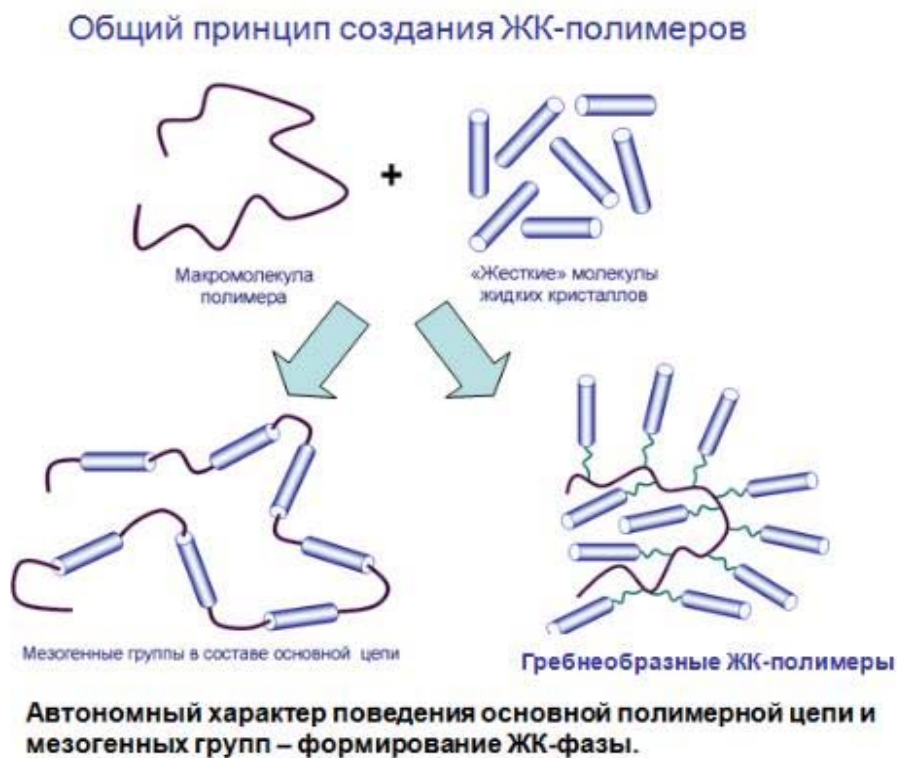
Рис.13. Общий принцип создания ЖК-полимеров
