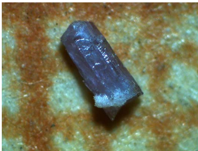
Рис.9. Одиночный кристалл \text{NdAl}_3(\text{BO}_3)_4 . На гранях отчетливо заметна штриховка – признак моноклинной сингонии.
